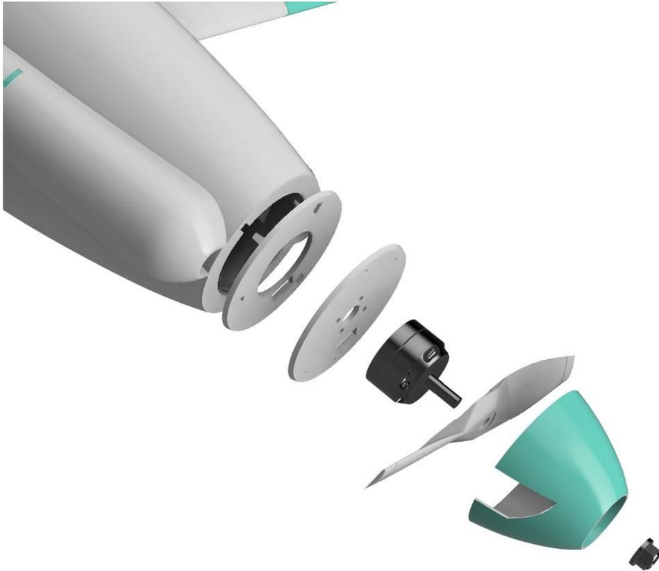
Die „Motorplate“ wird mit „Fusefront“ verklebt (auf Verzahnung achten). Danach den Motor auf den „Motormount“ schrauben. Der „Motormount“ hat 4 Aussparungen für Schrauben. Mit einem heißen Stück Klavierdraht entsprechende Löcher in „Motorplate“ machen um danach den Motormount mittels kleiner Treiberschrauben (zB Servobefestigungsschrauben) auf der Platte zu befestigen.
