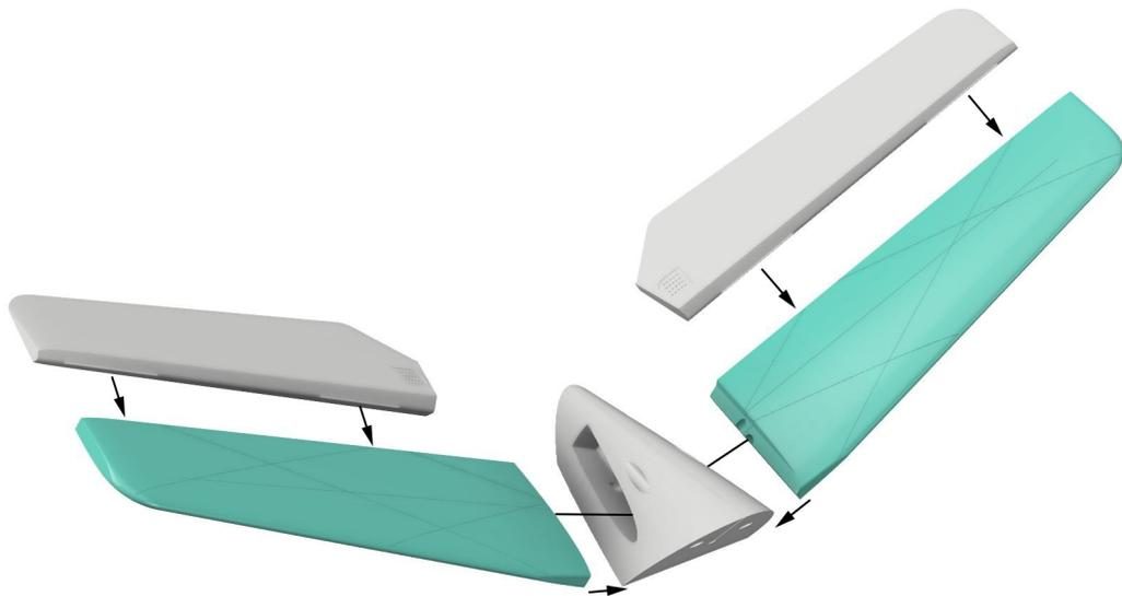
Die 4mm Carbonrohre auf Passung prüfen und gegebenenfalls kürzen. Die Rohre in VL und VR einführen und die Passung der Leitwerkshälften in den dafür vorgesehenen Ausnehmungen prüfen. Dann die Leitwerkshälften mit mittelflüssigem Sekundenkleber verkleben.
