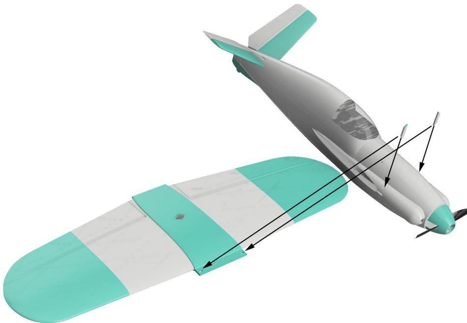
Wie bereits erwähnt können die Flügel fix verklebt oder abnehmbar ausgeführt werden. Für einen besseren Zugang im Falle eines Servoschadens ist eine abnehmbare Variante vorteilhaft.
